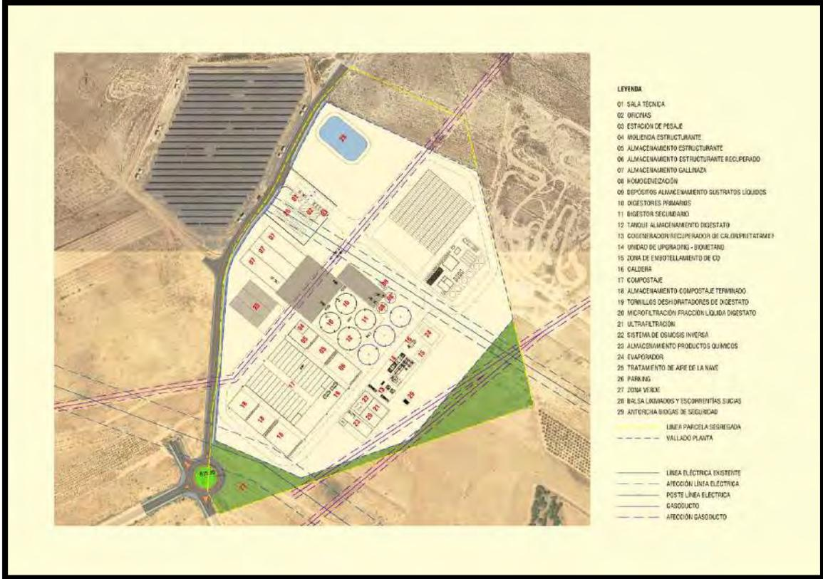
Figura 6: Diseño de la distribución de la planta sobre la ortofoto.
